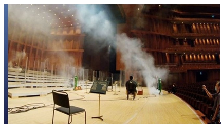
図4 スモークマシンを使った気流の実験
